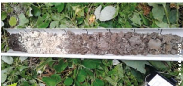
Contrôle des mesures compensatoires sur le port de Rouen. Suivant la hauteur d'apparition de traces d'oxydation ou de réduction observées sur cette gouttière graduée, le sol peut être retenu comme sol de zones humides ou non.
