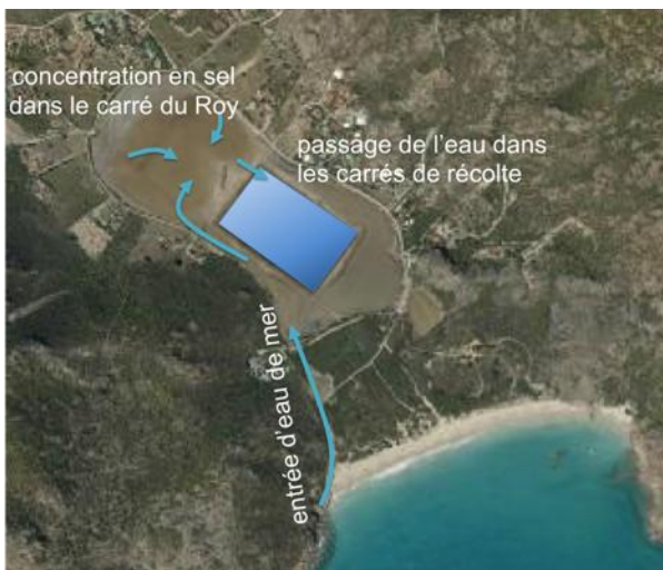
Figure 14 : Schéma de fonctionnement de la production de sel, l'ouverture et la fermeture du canal étant contrôlé
