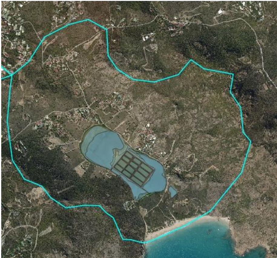
Figure 12 : Bassin versant de la Grande Saline : environ 190 ha (Safege 2000)
